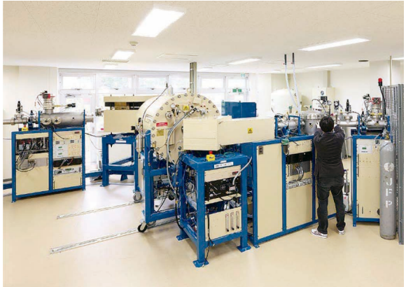
fig.5 かそくきぶんせきしつりようそうち AMS 加速器分析質量装置
