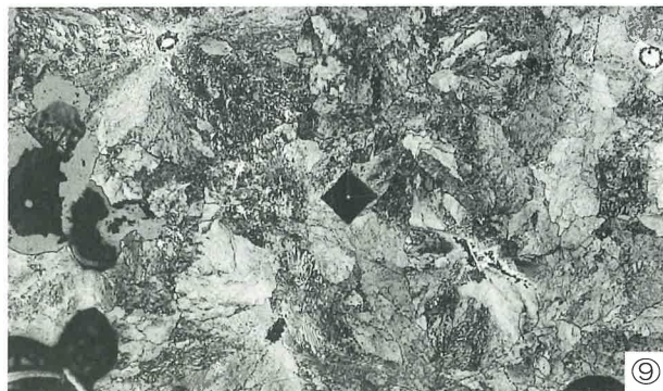
Photo. 11 鉄塊系遺物の顕微鏡組織
