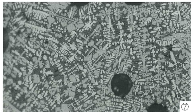
Photo.6 粒状滓の顕微鏡組織
