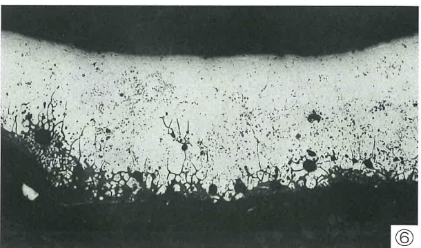
Photo.7 粒状滓・鍛造剥片の顕微鏡組織
