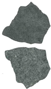
Photo.7 粒状滓・鍛造剥片の顕微鏡組織
