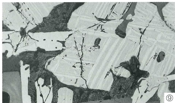
Photo. 3 再結合滓の顕微鏡組織
