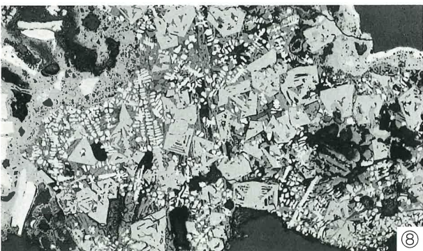
Photo.5 再結合滓の顕微鏡組織
