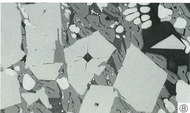
Photo.9 椀形鍛冶滓の顕微鏡組織
