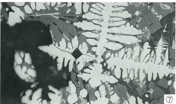
Photo.9 椀形鍛冶滓の顕微鏡組織
