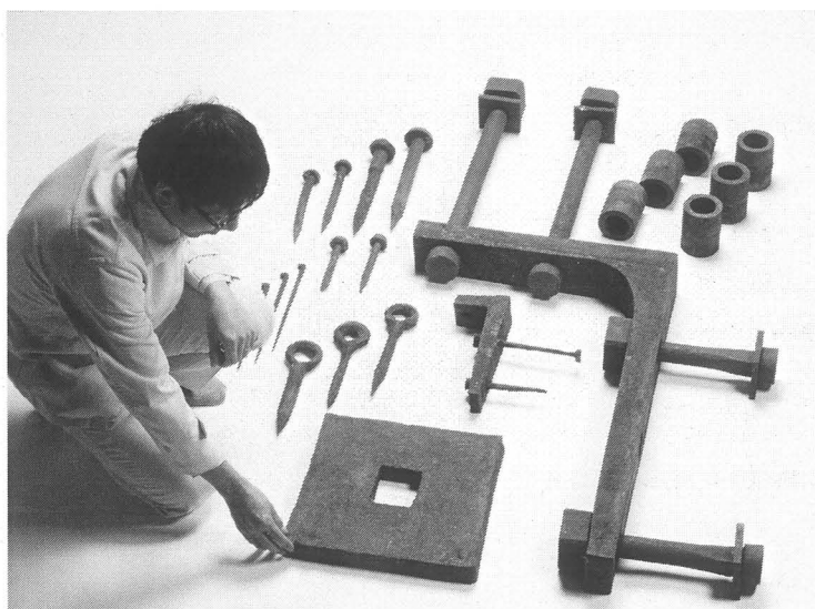
内部木造部を結合している金具類
