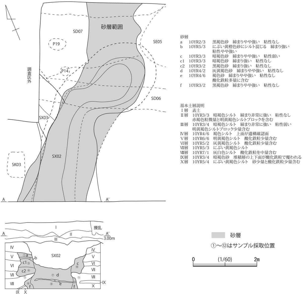
第43図 第2号周溝状遺構直下の砂層の堆積状況とその分布図
