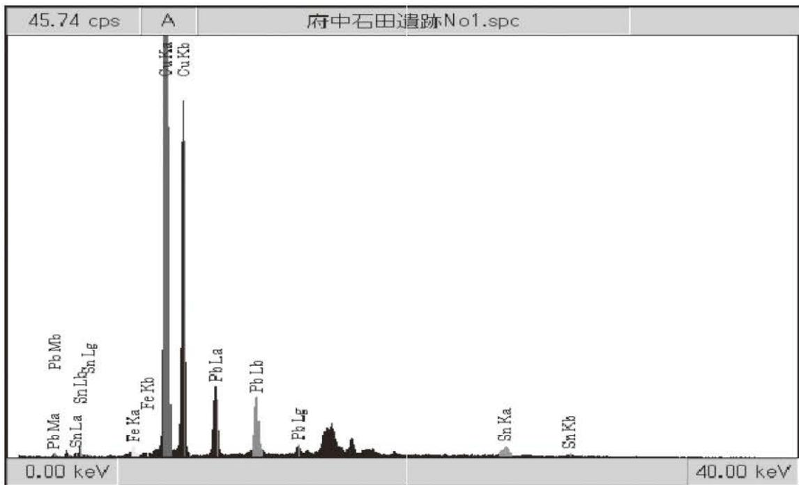
銅鏃から採取した試料のXRF スペクトル
