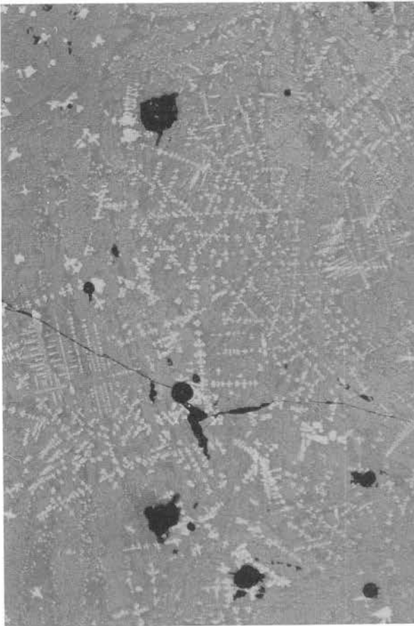
No. 6 製鍊付着炉壁 ×100
