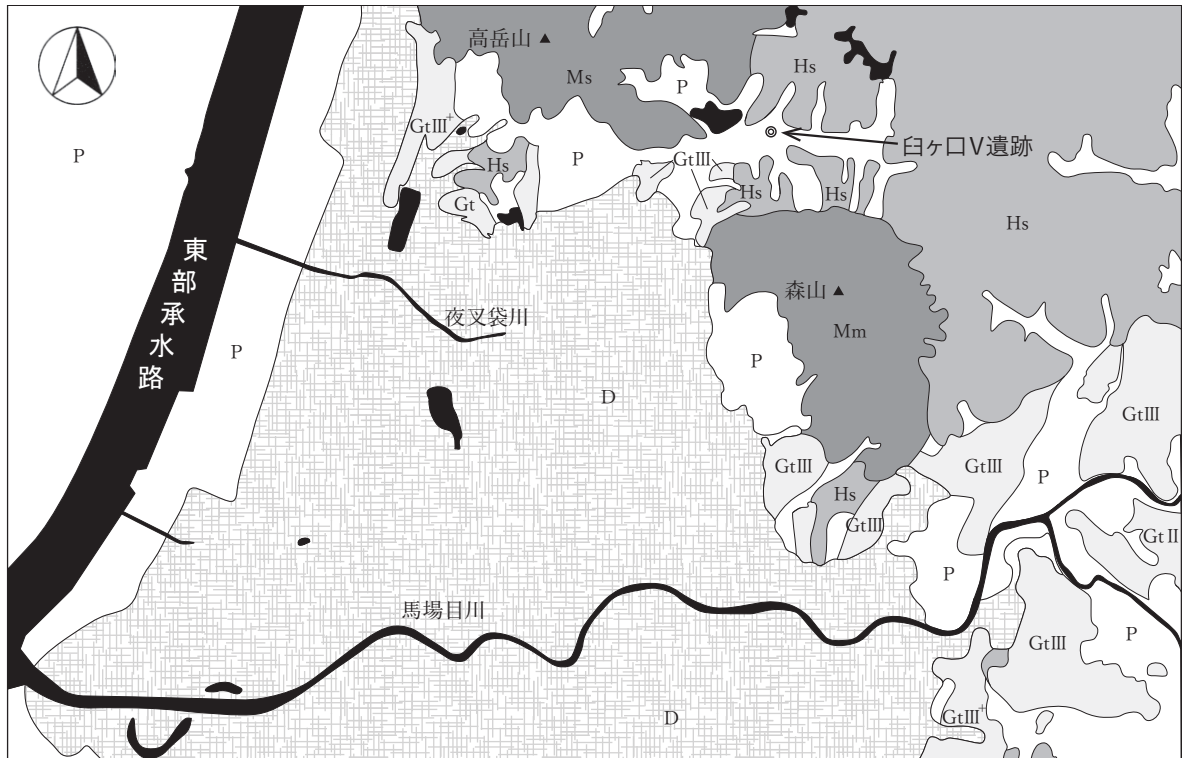
地形分類図 Mm：中起伏山地（起伏量400～200m）、Ms：小起伏山地（起伏量200m未満）、Hs：丘陵地Ⅱ（起伏量100m未満）、Gt：砂礫段丘（中位GtⅡ、低位GtⅢ + 、最低位GtⅢ）、D：三角洲および湖岸平野、P：谷底平野（扇状地・自然堤防および砂堆の低地、干拓地・人工改変地を含む）
