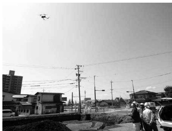
写真4 ドローンによる空中撮影
