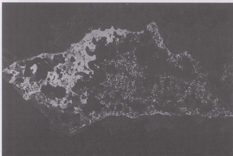
Photo12 上段：鉄塊系遺物（00Y-11）のマクロ組織（×10）
