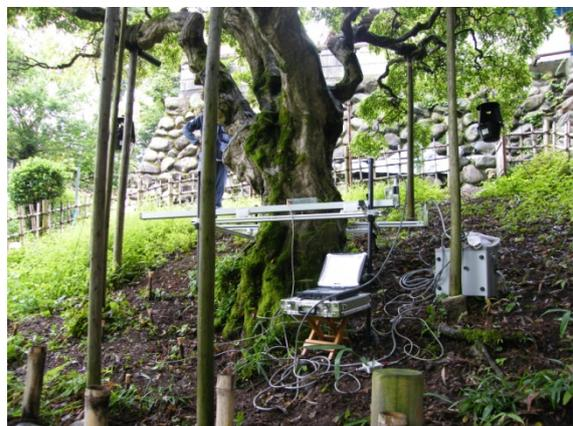
γ線樹木腐朽診断器による調査状況
