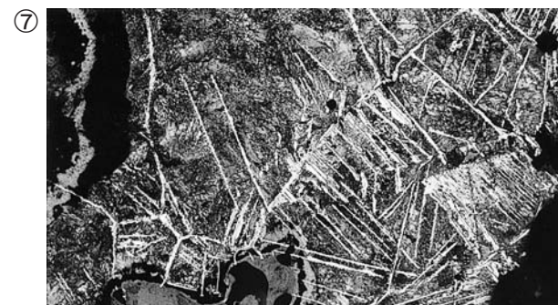
Photo.1 椀形鍛冶滓・鉄塊系遺物の顕微鏡組織
