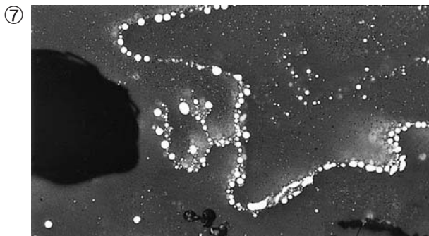
Photo.7 鑄造鉄器片・取鍋の顕微鏡組織
