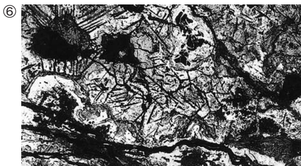
Photo.8 椀形鍛冶滓・鉄塊系遺物の顕微鏡組織
