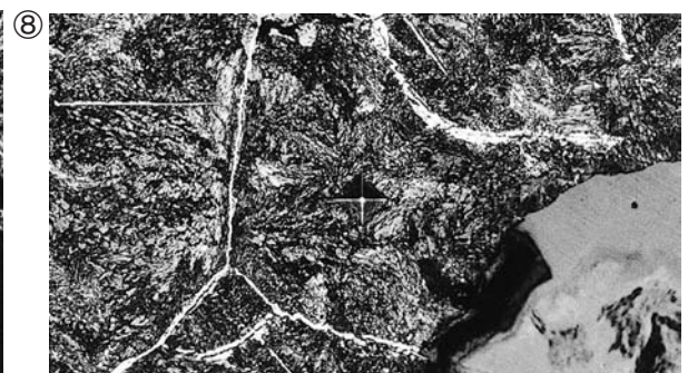
Photo.1 椀形鍛冶滓・鉄塊系遺物の顕微鏡組織
