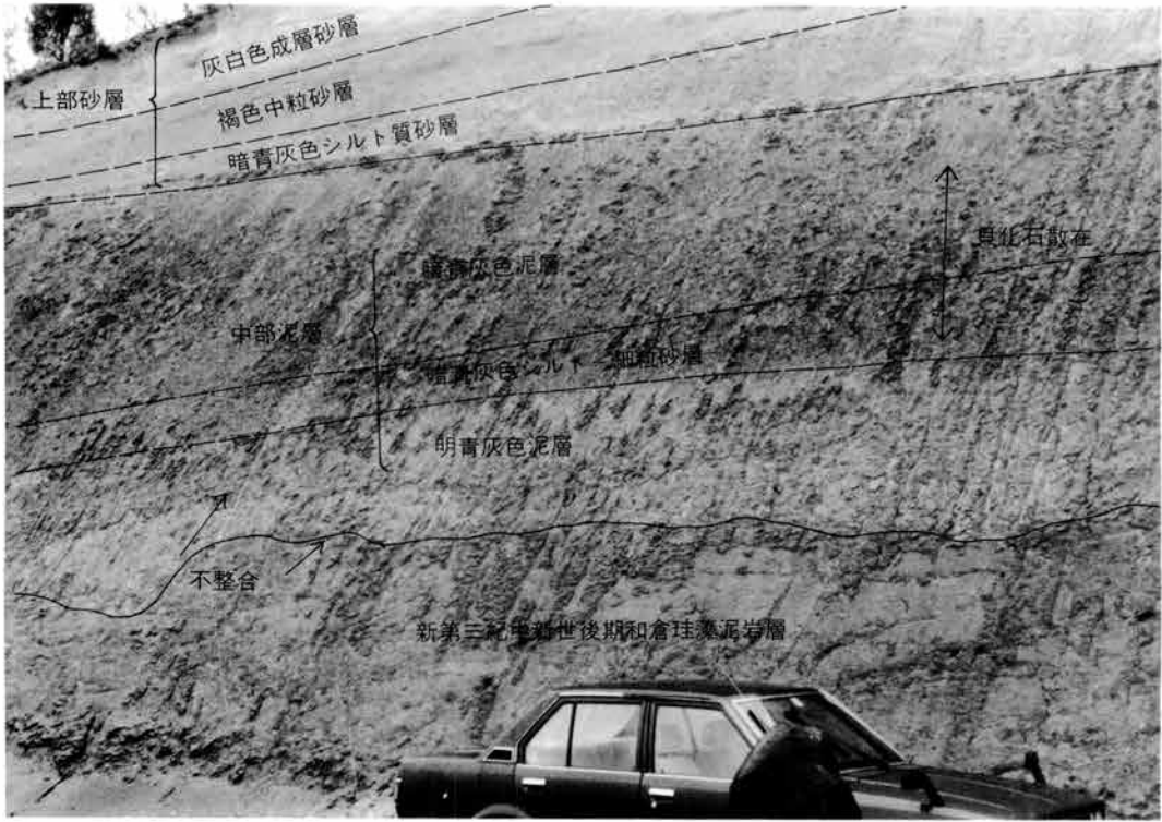
第5章 写真2 露頭写真 (写真1の左一西一側)、不整合より上が奥原層。
