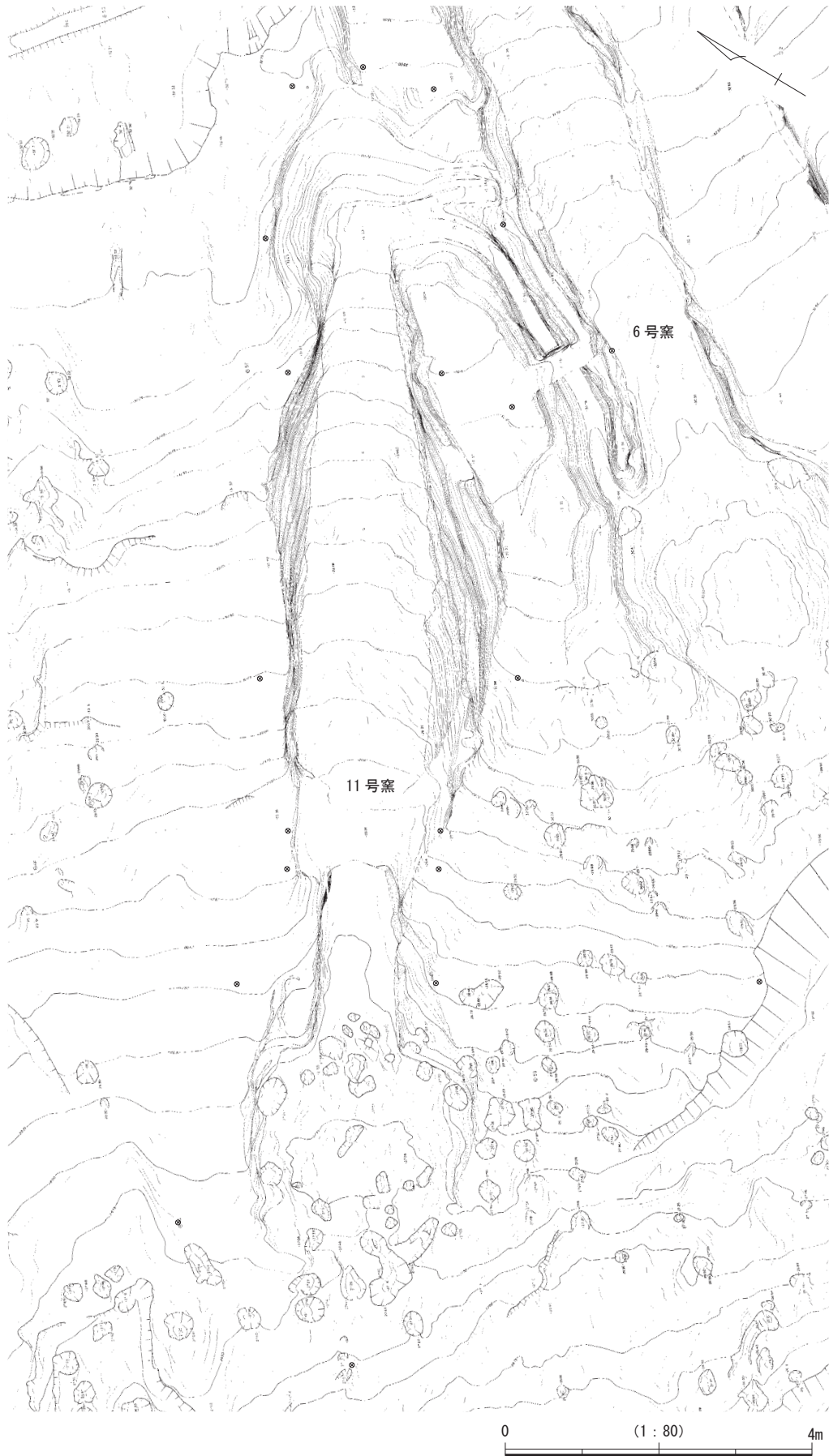
第 50 图 11 号窑平面图 1 (S=1/80)
