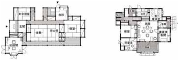
図5 中廊下型住宅と居間中心型住宅
