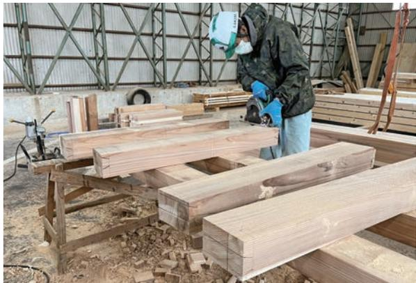
第114図 天秤ふいごの部材 (左:スギ材) と加工状況 (右) (令和4年度)
