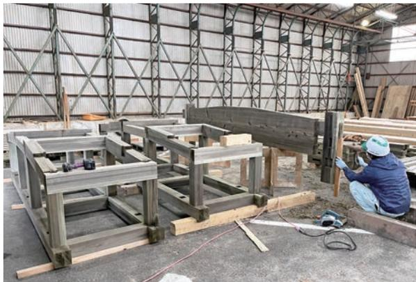
第115図 防腐剤を含浸処理した天秤ふいごの部材 (左) と組み立て状況 (右) (令和4年度)
