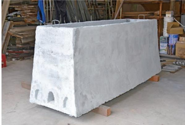
第112図 製鉄炉の製作状況 (左:メタルラス下地 右:モルタル塗り) (令和4年度)
