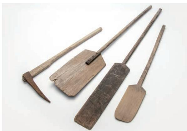
第81図 製鉄具（左から打鍬・種鋤・釜がい大・釜がい小）
