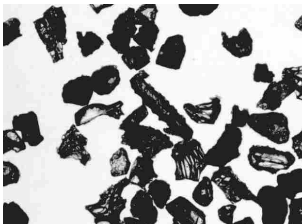
写真9 T1・試料1（軽石，透過光） As-SrやAs-Ok Groupの軽石を構成する火山ガ ラスや鉱物が多く含まれている。中央下：織 維束状軽石型ガラス、中央（有色鉱物）：斜 方輝石。
