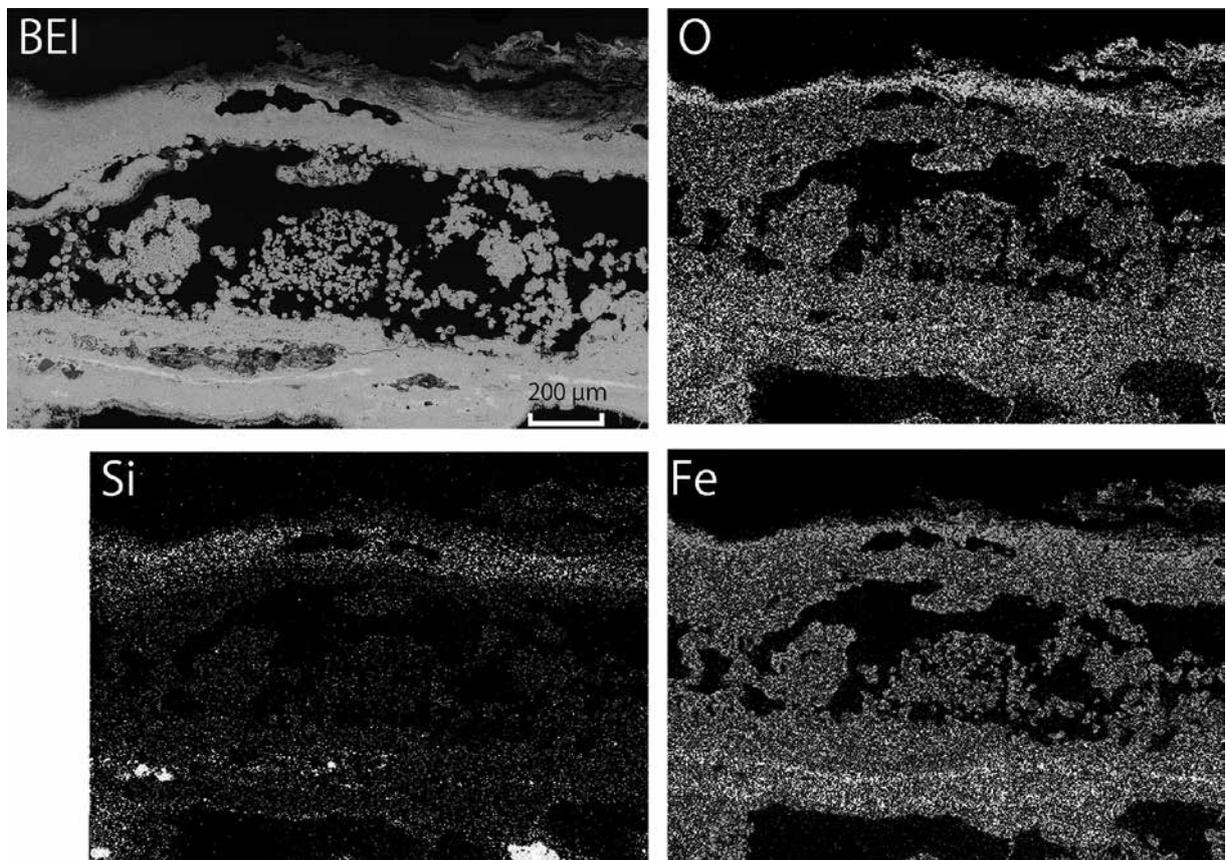
写真190 1号甲(腰札)外側の小札のSEM像とO、SiおよびFeの分布像
