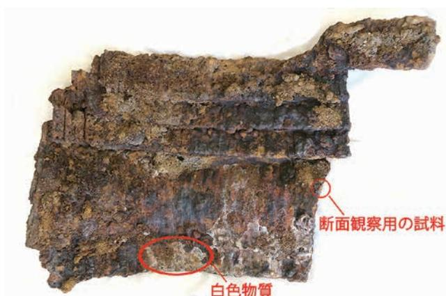
写真186 白色物質、断面観察用試料の採取箇所
