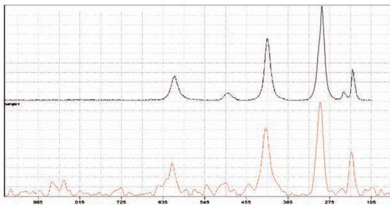
第95図 赤色顔料顕微ラマン分光スペクトル(上が赤鉄鉱(α-Fe₂O₃)の標準資料。下が分析資料)分析資料の各ピークは、標準資料によく一致している。
