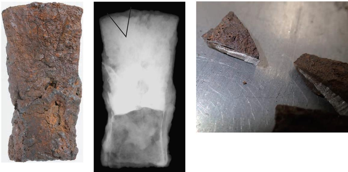
写真196 左から、金井東裏遺跡出土鉄斧とそのX線透過像、および採取試料
