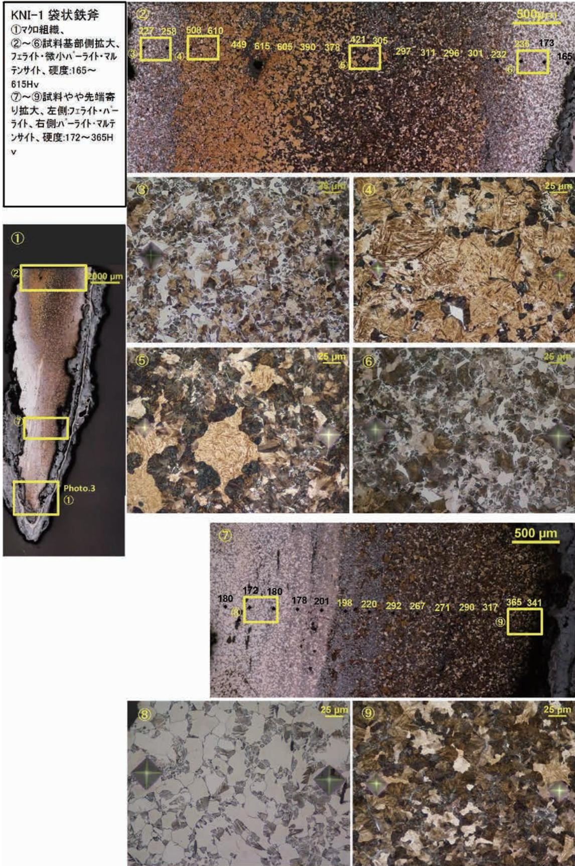
写真198 袋状鉄斧の顕微鏡組織
