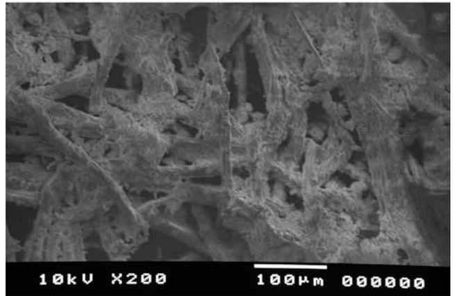
写真78 冑の小札に残存した繊維質資料のSEM画像
