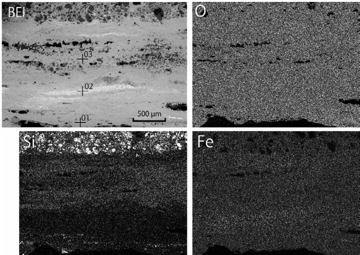
写真189 1号甲(腰札)内側の小札のSEM像とO、SiおよびFeの分布像
