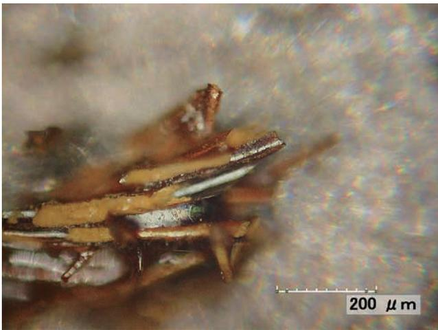
写真81 銻残存繊維質資料のデジタルマイクロスコープ画像 (1)
