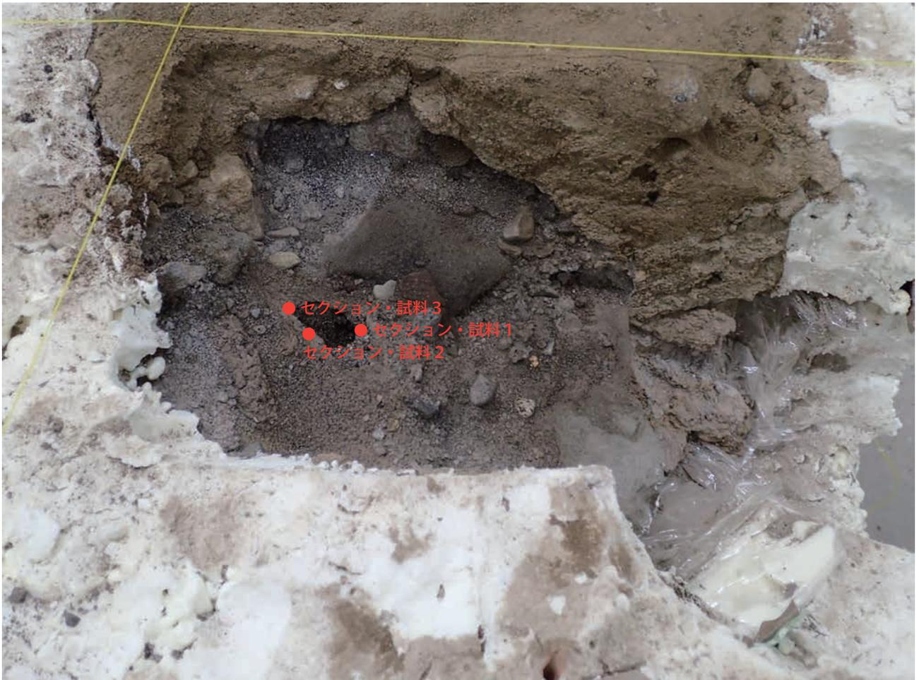
写真131 青切取ブロックと代表的分析試料の採取位置
