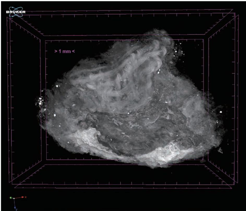
写真166 刀子に残る錆化した繊維状の物質を含む塊(マイクロCT像。1目盛りが1mm)
