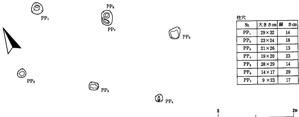
第276図 G III-8 掘立柱建物跡実測図
