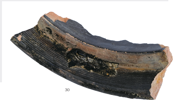
【SX15 旧第一海軍火薬廠甲排水路暗渠跡】 30：耐酸土管 (縮尺 = 1/6)
