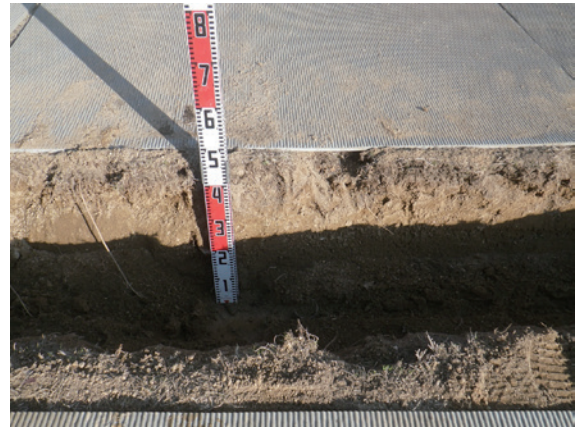
4 : 給水管南北方向南側 土層断面
