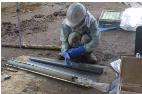
6 1区 ボーリング調査 (2020.7.27)
