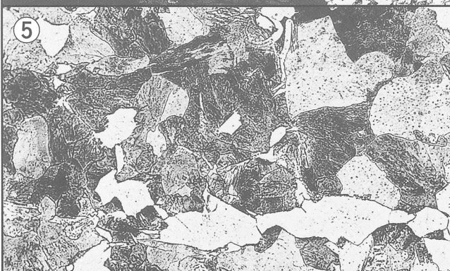
Photo.10 鉄斧の顕微鏡組織
