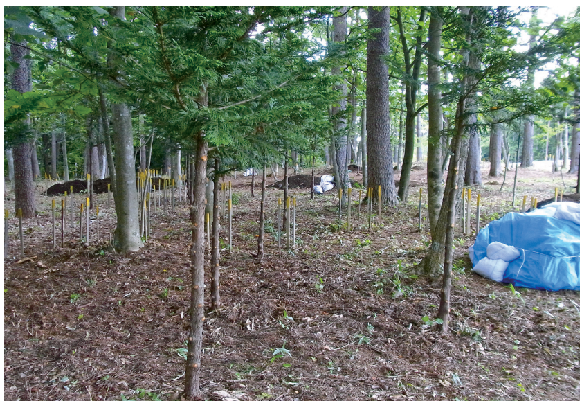
ボーリング調査状況 (黄色の杭が礫反応点)
