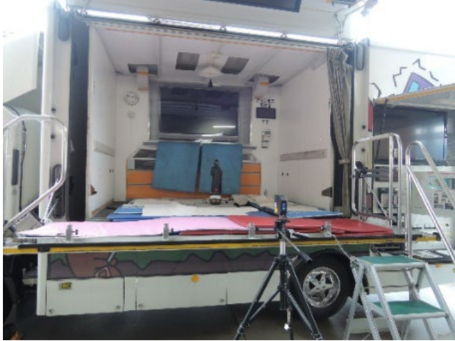
図2 起震車による転倒実験
