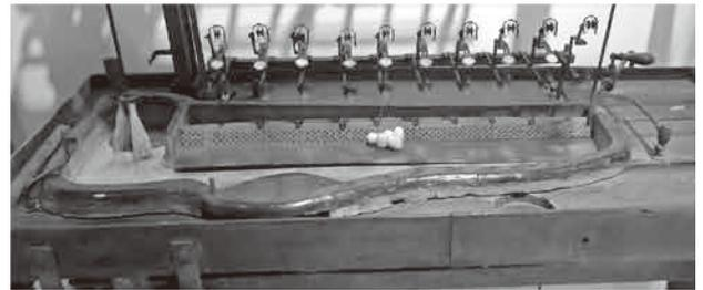
写真51 織田式10条繰糸機の陶器製繰糸鍋
