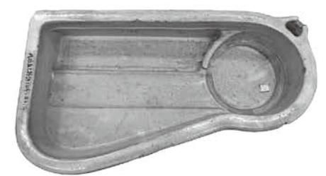
写真45a・c・d 索緒帯用YD式線糸鍋と側面「㊦、㊦」押印
