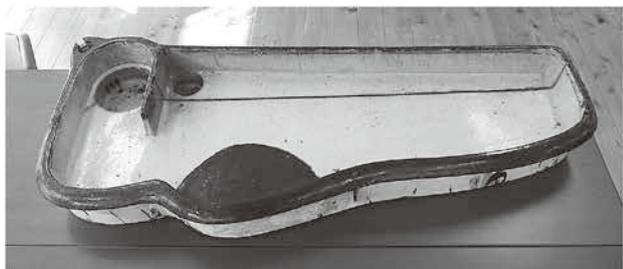
写真100 丸千組製の可能性が高い織田式10条繰糸鍋
