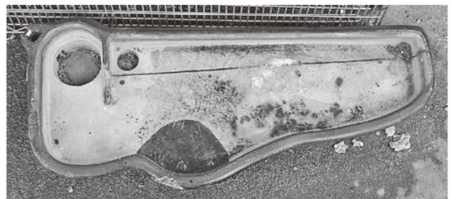
写真25a 丸千組製織田式10条繰糸鍋、「㊦」浮き文字がある
