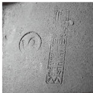
写真30c 側面の「信苧林工業製」と「○」押印
