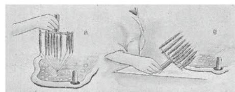
図23 丸子工業カタログ掲載のYD式索緒箒使用法の1部
