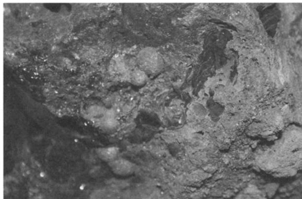
写真51 ガラスの質の滓中で生成した粒状の小鉄塊(第2層)
