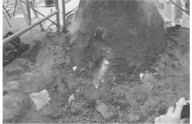
写真23 9:41 炉外に流れるノロ（流動滓）
