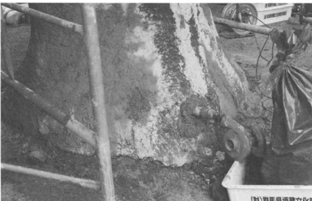
写真41 9:55 大口径羽口先端が詰まり、湯口(排滓孔)からの送風を試みる。
