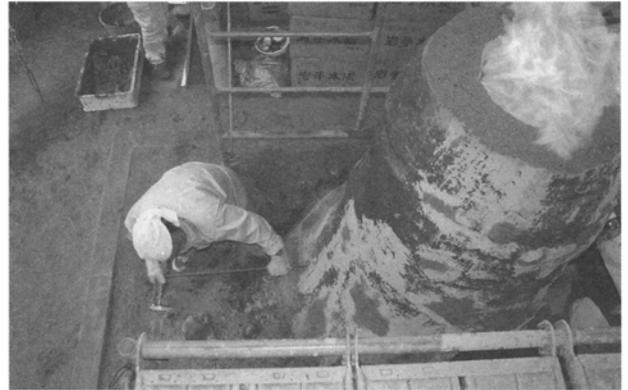
写真44 13:40 湯口(排滓孔)から流動滓を出そうと突くが、排滓孔より上面が厚く凝固しており、失敗。
