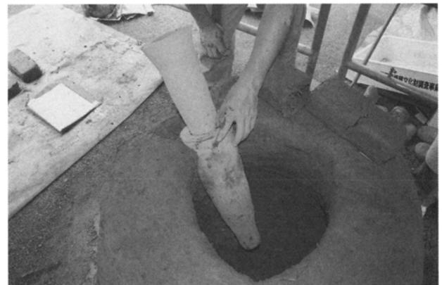
写真10 繋げて装着した大口径羽口
