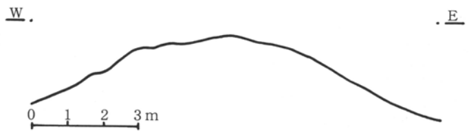
図7 少林山堂に残る堤防の断面実測図
