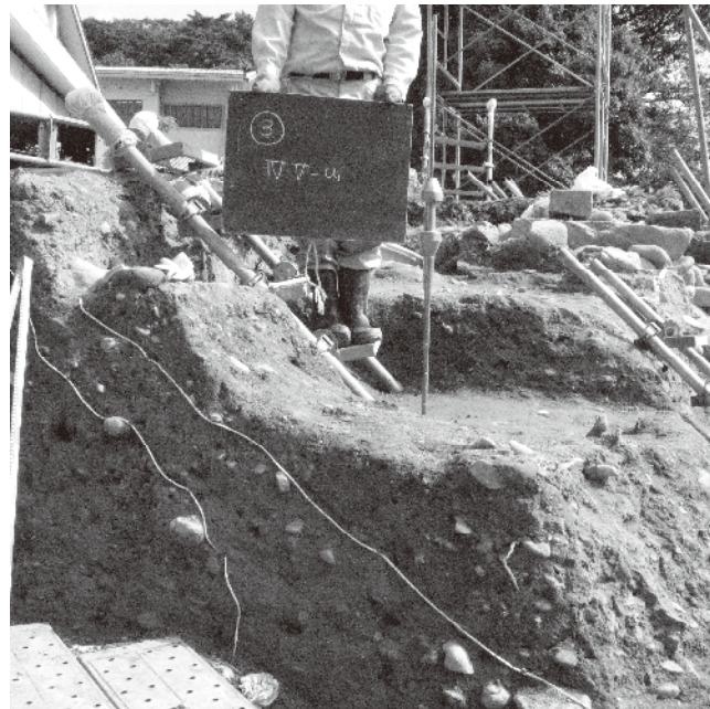
写真3-2 簡易動的コーン貫入試験状況
