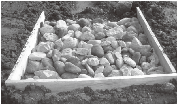
①緩詰め状態 落とし込みで充填
