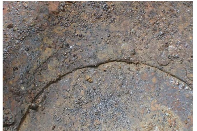
写真343 鉢内面地板第1段の尖った截断痕
