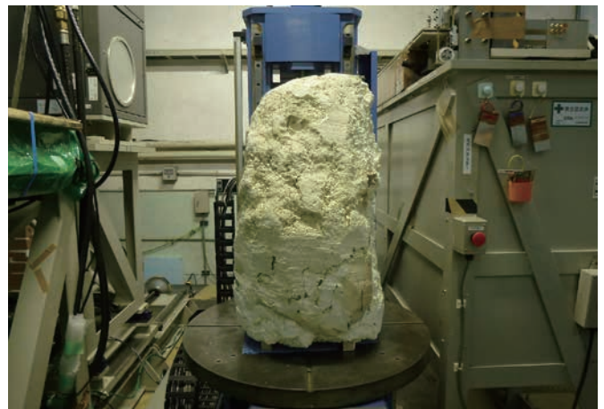
写真 232 X線CT撮影状況
