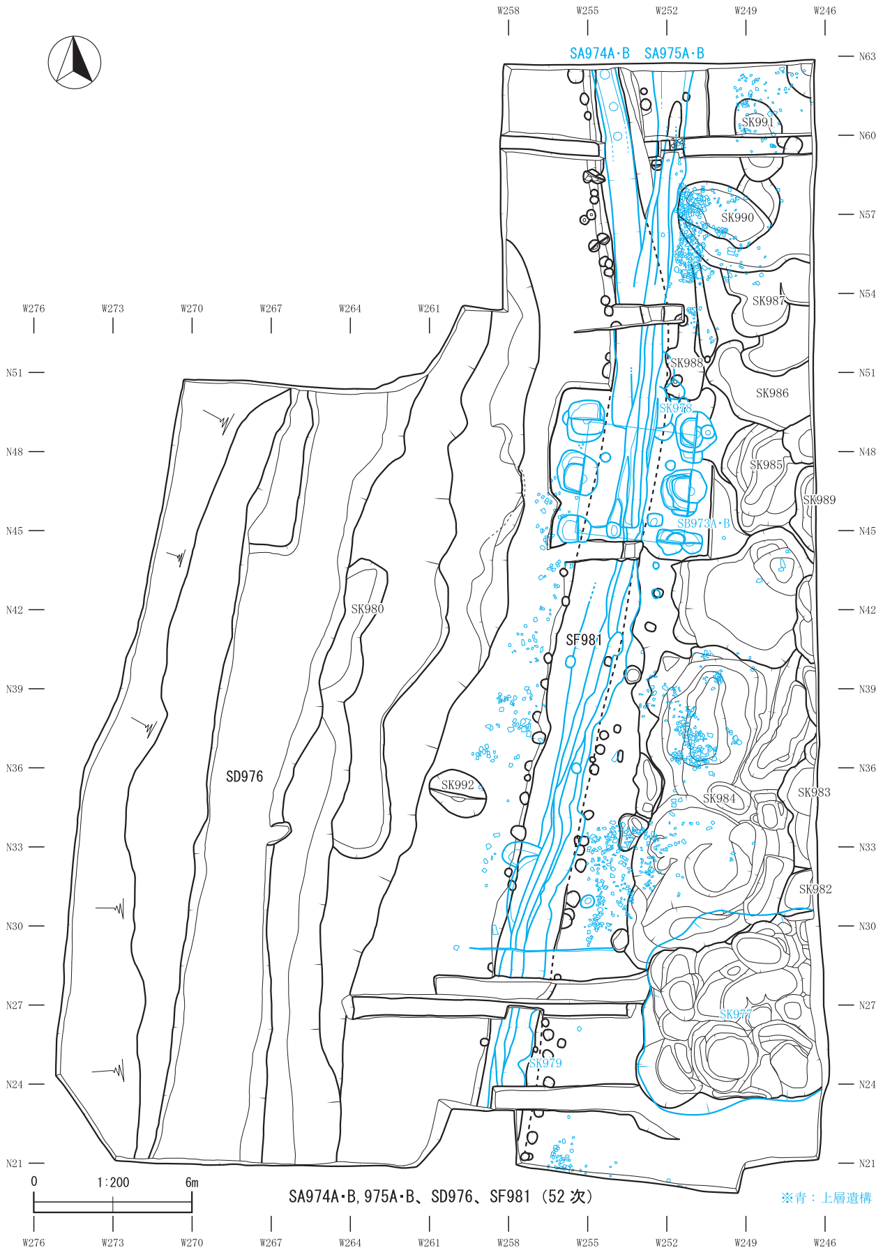
図 56 外部区画施設⑤(SA974A-B, 975A-B 材木塀跡、SD976 溝跡、SF981 築地塀跡)
