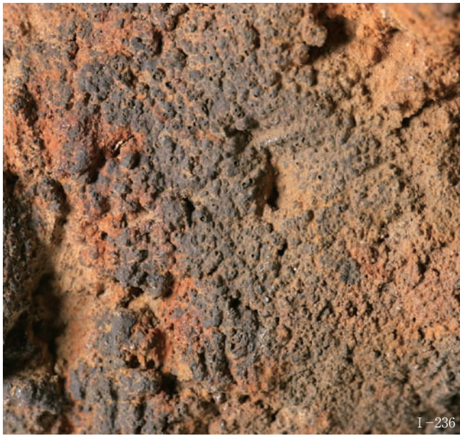
炉壁（砂鉄焼結付き）
