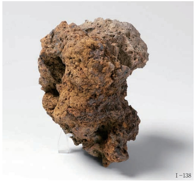
炉内滓（炉壁付き、含鉄）
