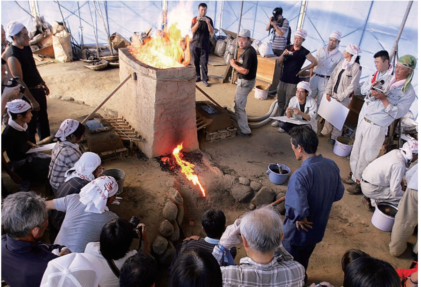
愛媛県今治市佐夜ノ谷遺跡の箱形炉を復元した製鉄実験
