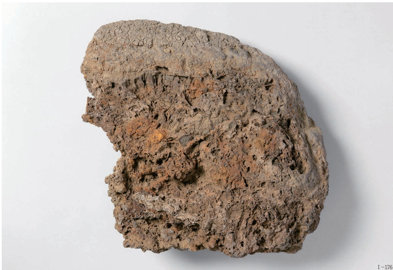
炉底塊A (裏面 炉床土付き)
