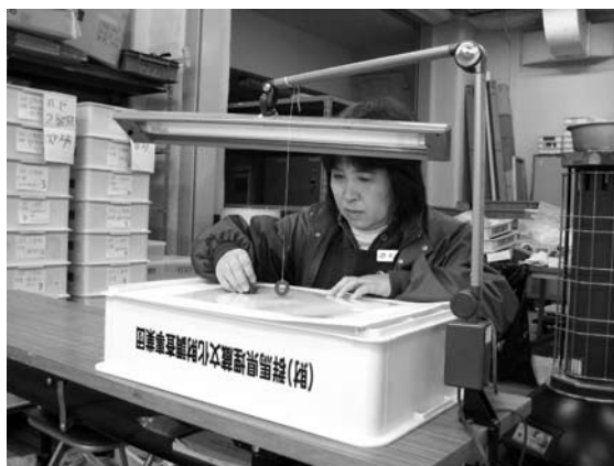
第28図 磁着度の測定
