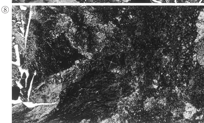
Photo.4 鉄塊系遺物の顕微鏡組織
