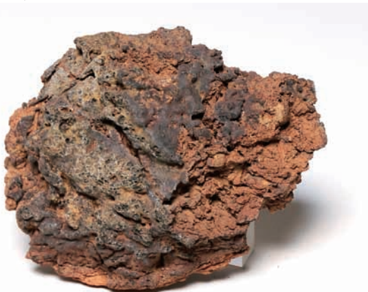
炉壁 (上段) 内面はわずかに発泡。 No. 3
