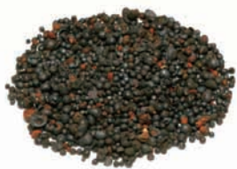
粒状滓 粘土汁と鉄の酸化物が飛散して球状化。
