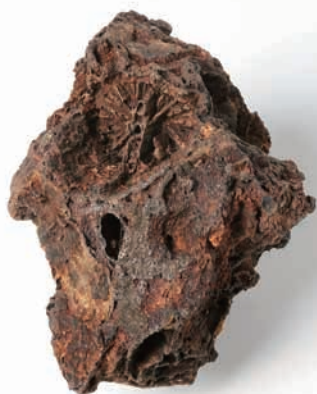
炉内滓 (内面) No.165 大型の木炭痕 (上) と錆色の目立つ典型的な炉内滓。
