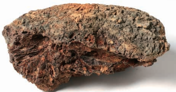
炉底塊 (炉壁付き) No.158 炉壁 (上) に沿って生成された炉底塊 (下)。上から撮影。
