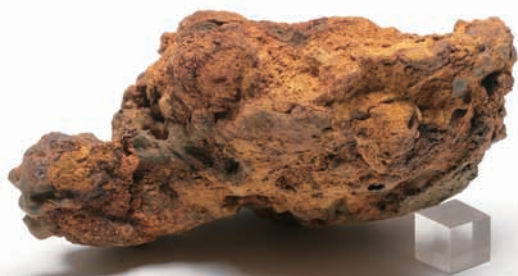
椀形鍛冶滓 完形に近い。上面が平坦で底部が椀形。 No.129
