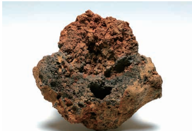
炉壁 (内面) 上半に砂鉄焼結が付着している。 No. 8
