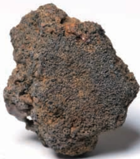
砂鉄焼結塊 砂鉄が還元しないまま結合した塊。 No.129
