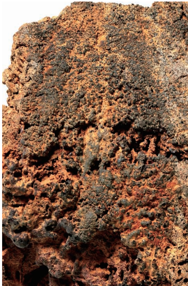
炉壁 (内面) 上半に砂鉄焼結が付着している。 No. 8
