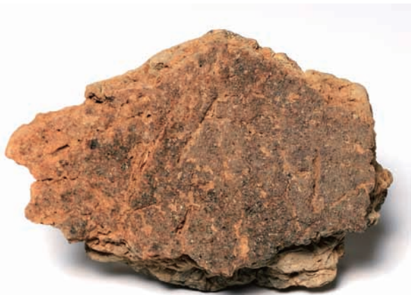
炉壁 (上段) 内面はわずかに発泡。 No. 3
