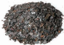
鍛造剥片 鉄素材の表面から剥離した酸化被膜。
