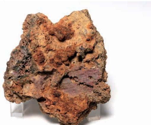
炉壁 (中段) 内面は滓化。 No.12
