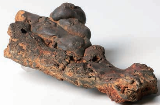
流出溝滓 扁平で気孔が多く、下面は槌状。 No.58
