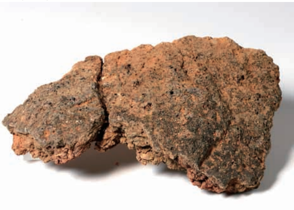
炉壁 (下段) 内面は溶損し、滓化が強い。 No.15
