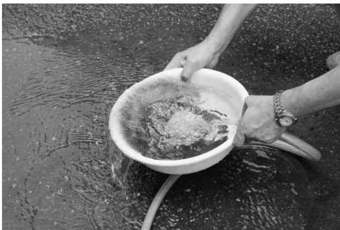
水流による砂鉄の分離
