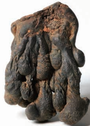
炉内流動滓 細い流動単位が重層する。 No.147
