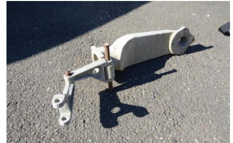
写真10： 陸軍四式戦闘機疾風の主脚下部部品で「トルクリンク」
