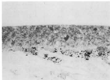
← No.3 漆椀 外面の断面 写真(×200)
