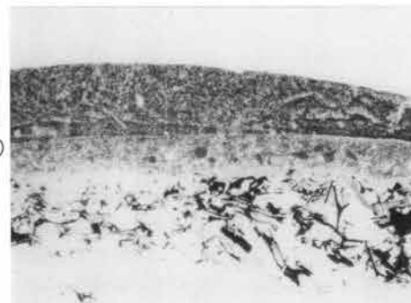
← No.3 漆椀 口縁端部の 断面写真 (×200)
