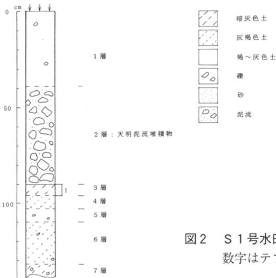
図1 S1号水田セクションA-A'の土層柱状図
