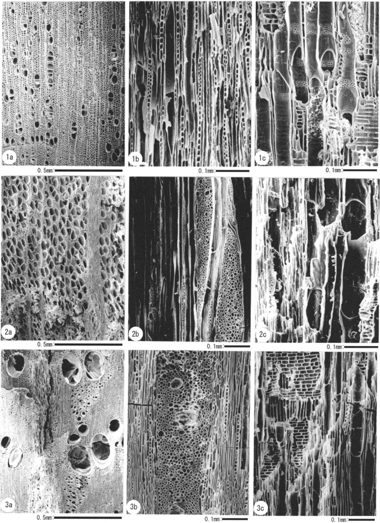
図版1 下原遺跡Ⅲ区-1G 1号住居出土炭化材組織の走査電子顕微鏡写真
