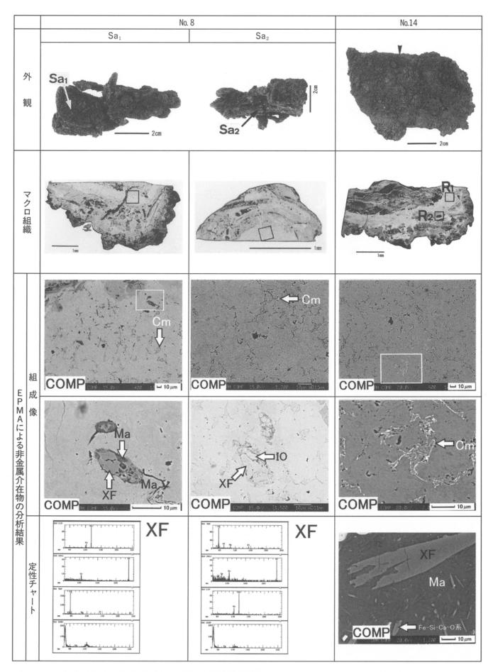
図11 No.8 およびNo.14の外観と摘出した試料の組織観察結果
