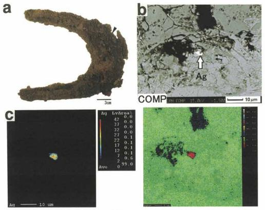
写真 2 No.9 鋤先の外観と Sa<sub>1</sub> 部から摘出した試料に見出された非金属介在物に含有される元素濃度 分布のカラーマップ
