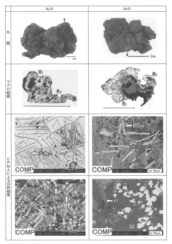
図14 No.34・No.43の外観と摘出試料の組織観察結果
