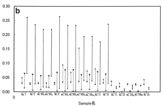
図1 調査対象とした鉄器内部および表層面から摘出した試料に含有される微量元素濃度の比較 a: Cu・Ni・Co 三成分の比較
