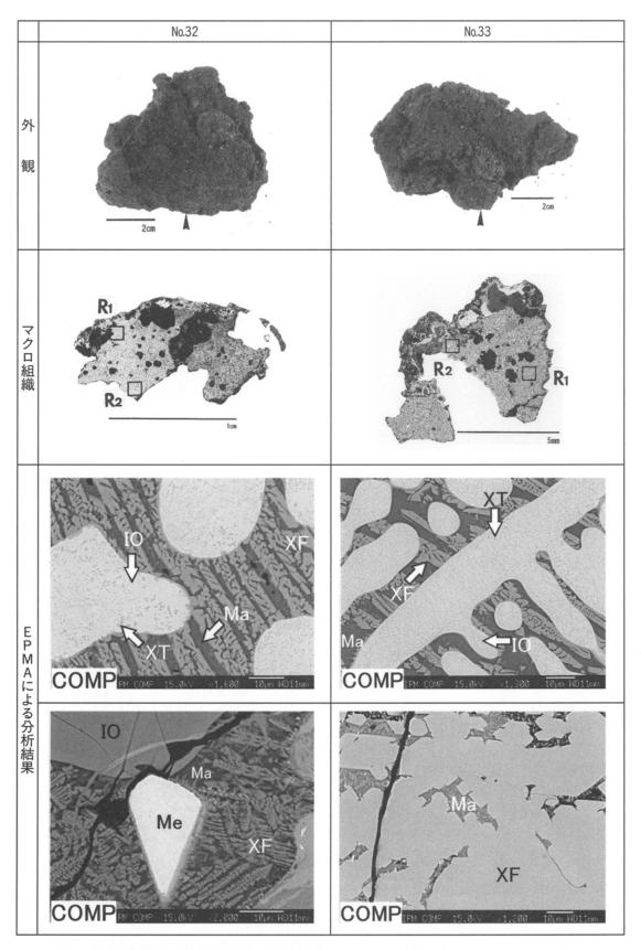
図17 No.32・No.33の外観と摘出した試料の組織観察結果 外観の矢印は試料摘出位置。EPMAの組成像(COMP)上段はマクロ組織領域 R<sub>1</sub>内部、組成像下段はマクロ組織 領域 R<sub>2</sub>内部。Me:鉄粒、IO:酸化鉄、XT:鉄チタン酸化物、XF:Fe-Mg-Si-O系化合物、Ma:マトリックス。
