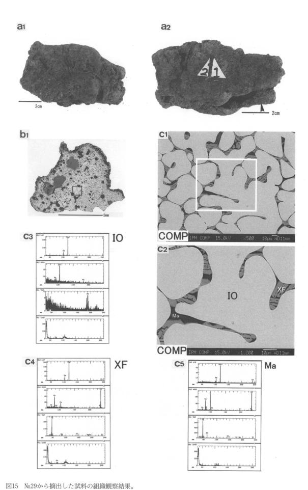
$a_1 \cdot a_2$ : 外観、矢印は試料摘出位置。 $b_1$ : マクロ組織。 $c_{1-5}$ :  $b_1$ 枠内部の EPMA による組成像(COMP)と定性分析結果。IO: 酸化鉄、XF: Fe-Mg-Si-O 系化合物、Ma: マトリックス。
