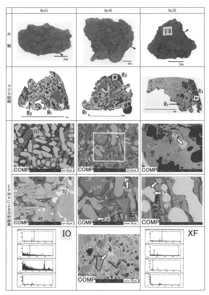
図19 No.41 · No.45 · No.30の外観と摘出した試料の組織観察結果
