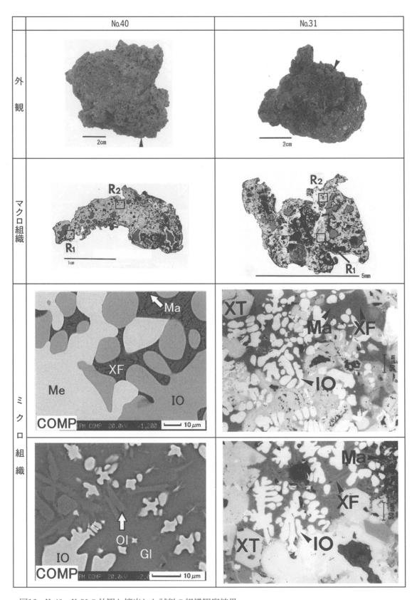
図16 No.40・No.31の外観と摘出した試料の組織観察結果
