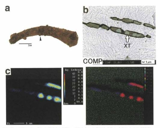
写真 1 No.16鎌の外観と Sa, 部から摘出した試料に見出された非金属介在物に含有される元素濃度 分布のカラーマップ
