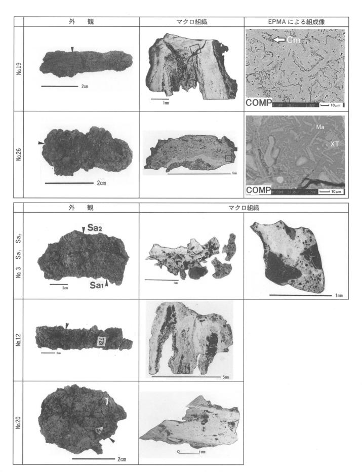
図13 No.3 • No.12 • No.19 • No.20 • No.26の外観と摘出した試料の組織観察結果 外観の矢印は試料摘出位置。EPMA による組成像 (COMP) はマクロ組織の枠内部。Cm はセメンタイトまたはその欠落孔。XT:鉄チタン酸化物、Ma:マトリックス。
