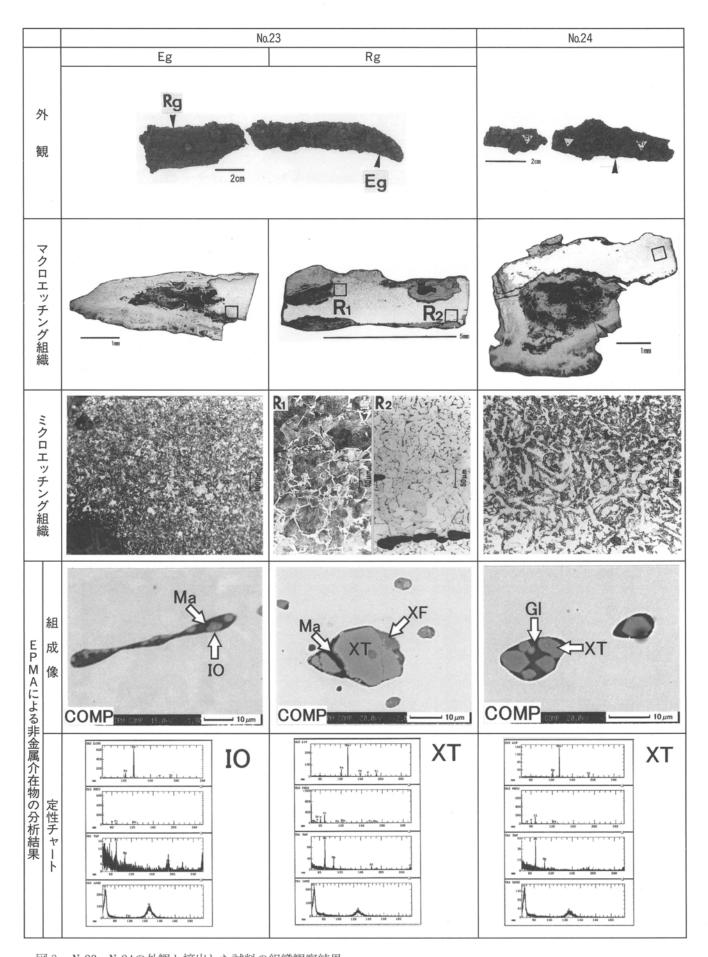
図 8 No.23・No.24の外観と摘出した試料の組織観察結果 外観の矢印は試料摘出位置。No.23Eg およびNo.24のミクロエッチング組織はマクロエッチング組織の枠内部。No.23Rg のミクロエッチング組織をはマクロエッチング組織領域  $R_1$ 内部、ミクロエッチング右はマクロエッチング組織領域  $R_2$ 内部。エッチングはナイタールによる。IO:酸化鉄、XT:鉄チタン酸化物、XF:Fe-Mg-Si-O 系化合物、Ma:マトリックス。
