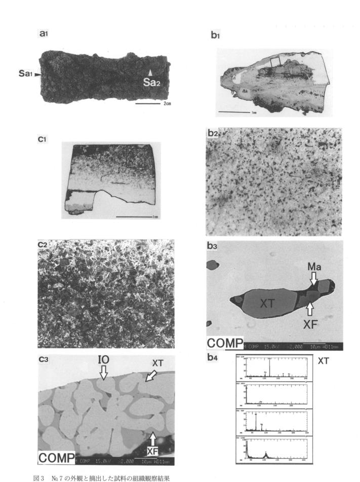
$a_1$ : 外観。矢印は試料摘出位置。 $b_1 \cdot c_1$ : それぞれ  $a_1$ の  $Sa_1$ 部、 $Sa_2$ 部から摘出した試料のマクロエッチング組織。エッチングはナイタールによる。 $b_2 \cdot c_2$ : それぞれ  $b_1$ 、 $c_1$ 枠内部のミクロエッチング組織。 $b_3 \cdot b_4$ :  $b_1$ に見出された非金属介在物の EPMA による組成像(COMP)と定性チャート。 $c_3$ :  $c_1$ に見出された非金属介在物の EPMA による組成像(COMP)。IO:酸化鉄、XT:鉄チタン酸化物、XF:Fe-Mg-Si-O 系化合物、Ma:マトリックス。
