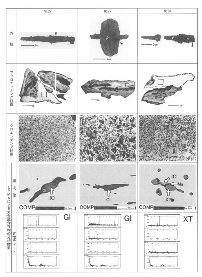
図9 No.25・No.27・No.28の外観と摘出した試料の組織観察結果 外観の矢印は試料摘出位置。ミクロエッチング組織はマクロエッチング組織の枠内部。エッチングはナイタールによる。IO:酸化 鉄、XT:鉄チタン酸化物、GI:ガラス質ケイ酸塩、Ma:マトリックス。
