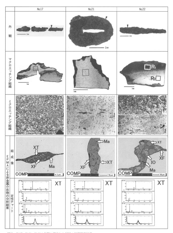
図7 No.17・No.21・No.22の外観と摘出した試料の組織観察結果 外観の矢印は試料摘出位置。No.17およびNo.21のミクロエッチング組織はマクロエッチング組織の枠内部。No.22のミクロエッチング 組織上段はマクロエッチング組織領域  $R_1$  内部。ミクロエッチング下段はマクロエッチング組織領域  $R_2$ 内部。エッチングはナイタールによる。IO:酸化鉄、XT:鉄チタン酸化物、XF:Fe-Mg-Si-O 系化合物、Ma:マトリックス。
