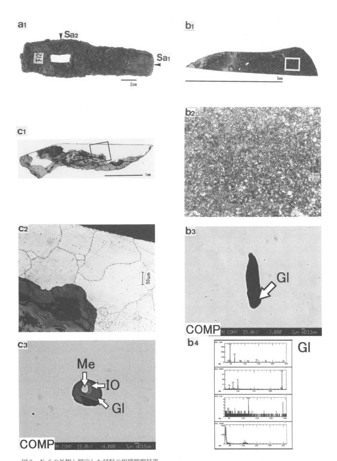
図2 No.6の外観と摘出した試料の組織観察結果
