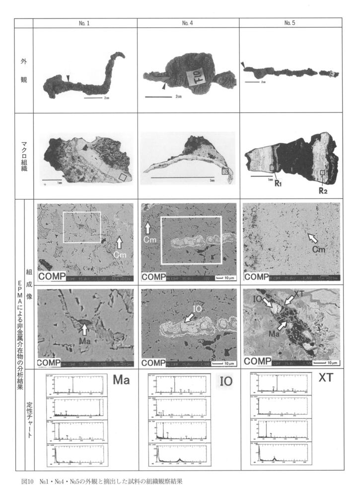
外観の矢印は試料摘出位置。 $N_0$  1 および $N_0$  4 の EPMA による組成像 (COMP) 上段はマクロ組織の枠内部。組成像下段は組成像上段の枠内部を拡大。 $N_0$  5 の組成像上段および下段はそれぞれ、マクロ組織領域  $R_1$ 、 $R_2$ 内部。IO:酸化鉄、XT:鉄チタン酸化物、Ma:マトリックス。
