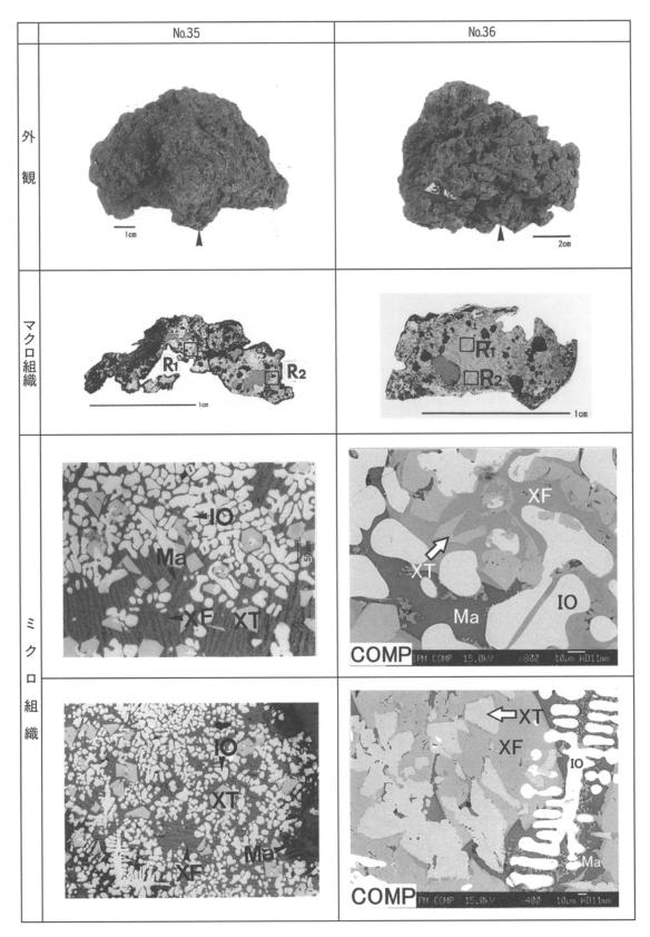
図18 No.35・No.36の外観と摘出試料の組織観察結果 外観の矢印は試料摘出位置。No.36の EPMA の組成像 (COMP) およびNo.35のミクロ組織上段はマクロ組織領域  $R_1$  内部、No.36の EPMA の組成像 (COMP) 下段およびNo.35のミクロ組織下段はマクロ組織領域  $R_2$ 内部。IO:酸化鉄、XT:鉄チタン酸化物、XF:Fe-Mg-Si-O 化合物、Ma:マトリックス。
