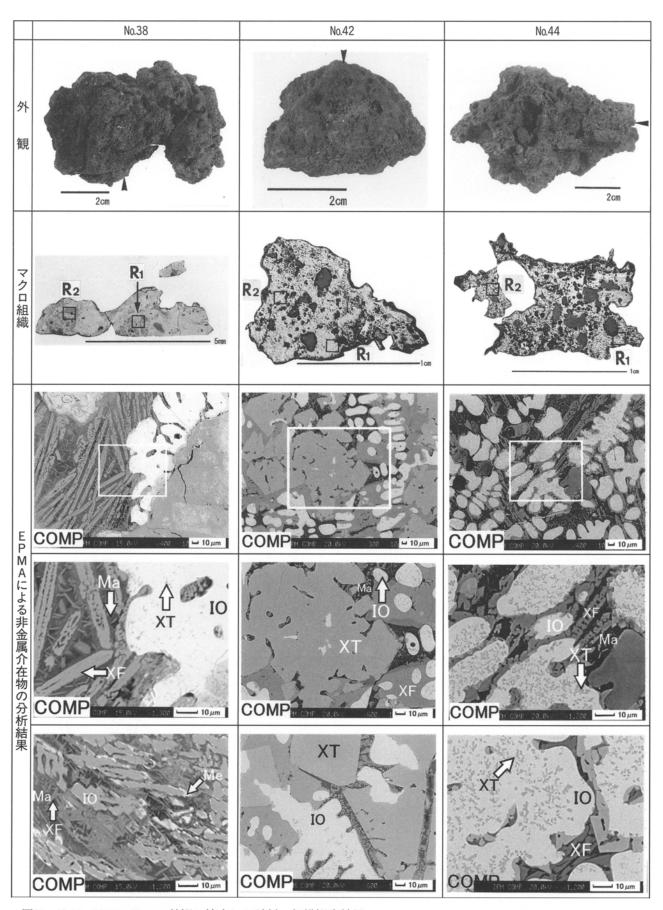
図21 No.38・No.42・No.44の外観と摘出した試料の組織観察結果 外観の矢印は試料摘出位置。EPMA の組成像(COMP)上段はマクロ組織の領域  $R_1$ 内部、組成像下段はマクロ組織領域  $R_2$ 内部。組成像中段は組成像上段の枠内部を拡大。IO:酸化鉄、XT:鉄チタン酸化物、XF:Fe-Mg-Si-O 系化合物、Ma:マトリックス。
