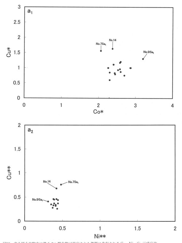
図22 非金属介在物中に鉄チタン酸化物が見出された鉄器に含有される Cu・Ni・Co 三成分比 Noは表 1 に対応。 Cu\*: (mass%Cu)/(mass%Ni)、Co\*: (mass%Co)/(mass%Ni)、Cu\*\*: (mass%Cu)/(mass%Co)、Ni\*\*: (mass%Ni)/(mass%Co)。
