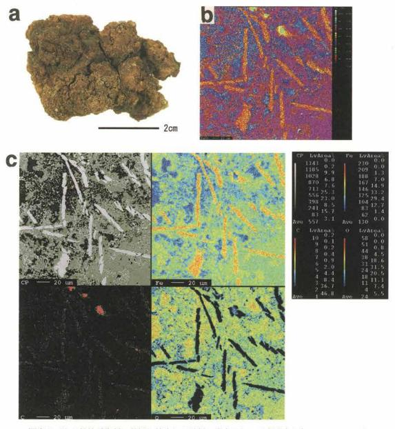
写真 3 No.43鉄塊系資料の外観と摘出した試料に含有される元素濃度分布のカラーマップ a:外観。b:Fe・C・Oの複合カラーマップ。 c:EPMAによる組成像 (COMP) と Fe、C、Oの濃度分布。
