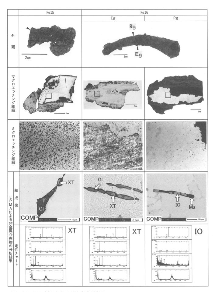
図 6 No.15・No.16の外観と摘出した試料の組織観察結果 外観の矢印は試料摘出位置。ミクロエッチング組織はマクロエッチング組織の枠内部。エッチングはナイタールによる。IO:酸化 鉄、XT:鉄チタン酸化物、GI:ガラス質ケイ酸塩、Ma:マトリックス。
