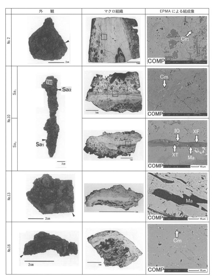
図12 No.2 • No.10 • No.13 • No.18の外観と摘出した試料の組織観察結果 外観の矢印は試料摘出位置。EPMA による組成像 (COMP) はマクロ組織の枠内部。Cm はセメンタイトまたはその欠落孔。IO: 酸化鉄、XT:鉄チタン酸化物、XF:Fe-Mg-Si-O 系化合物、Ma:マトリックス。
