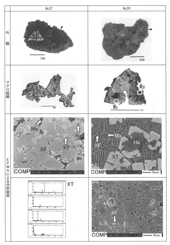
図20 No.37・No.39の外観と摘出試料の組織観察結果
