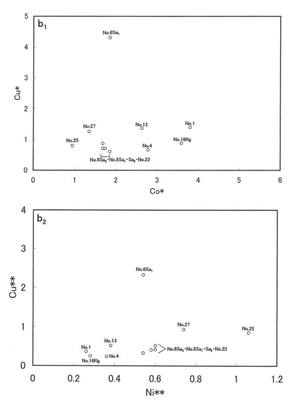
図23 非金属介在物中に鉄チタン酸化物が見出されなかった鉄器に含有される Cu・Ni・Co 三成分比 Noは表 1 に対応。 Cu\*: (mass%Cu)/(mass%Ni)、Co\*: (mass%Co)/(mass%Ni)、Cu\*\*: (mass%Cu)/(mass%Co)、Ni\*\*: (mass%Ni)/(mass%Co)。
