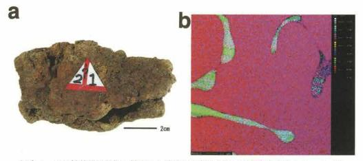
写真 4 No.29 椀状滓の外観と摘出した試料に含有される元素濃度分布のカラーマップ a: 外観。b: Fe · Si · Oの複合カラーマップ。
