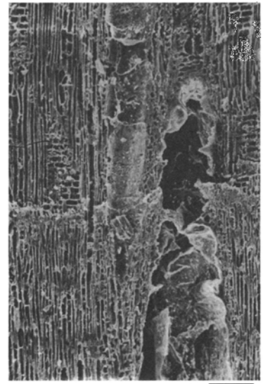
1 c コナラ節 (放射断面) bar : 0.1mm
