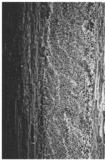
2 b クヌギ節 (接線断面) bar : 0.5mm
