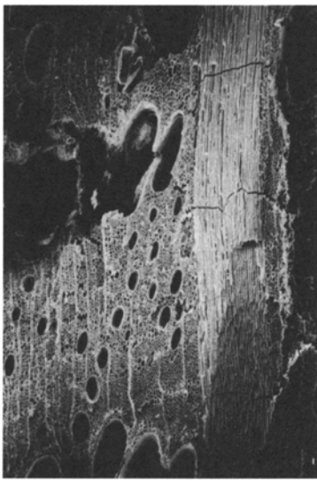
2 a クヌギ節 (横断面) 試料No15 bar : 0.5mm
