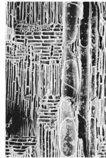
6c クリ (放射断面) No.42 bar : 0.1mm
