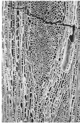
5b クヌギ節 (接線断面) No.4 bar : 0.5mm
