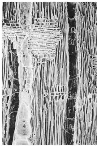
9c ヤマグワ (放射断面) No.11 bar : 0.1mm
