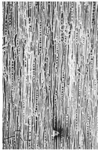
6b クリ (接線断面) No.42 bar : 0.5mm
