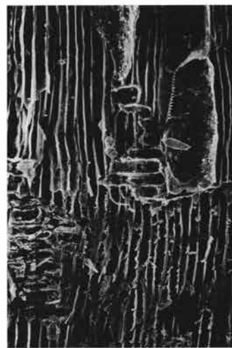
3c ヤシャブシ亜属 (放射断面) No.36 bar : 0.1mm
