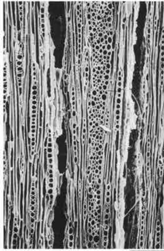
4b コナラ節 (接線断面) No.60 bar : 0.1mm
