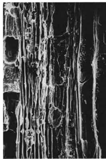
2c ヤナギ属 (放射断面) No.13 bar : 0.1mm
