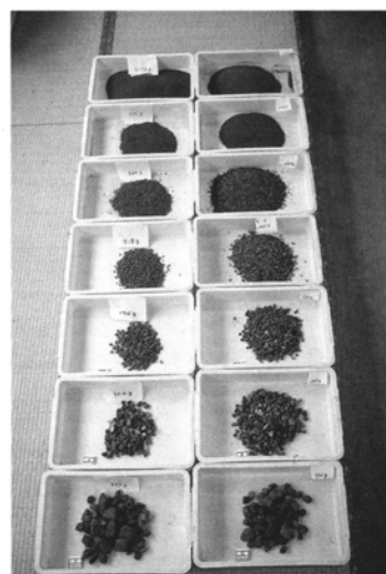
写真7. 逆級化構造の砂層篩分け。
