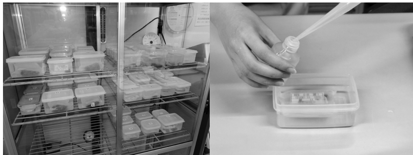
脱塩処理状況・脱塩液採取状況
