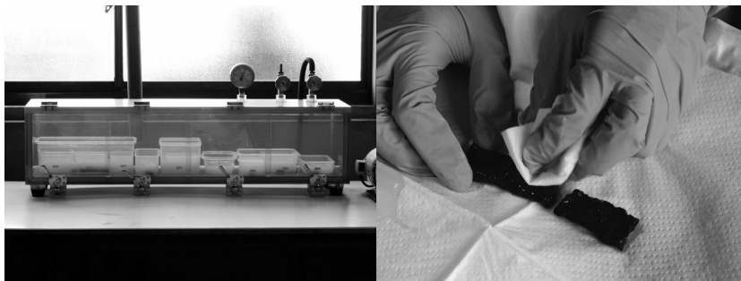
樹脂含浸、取上げ・余分な樹脂のふき取り
