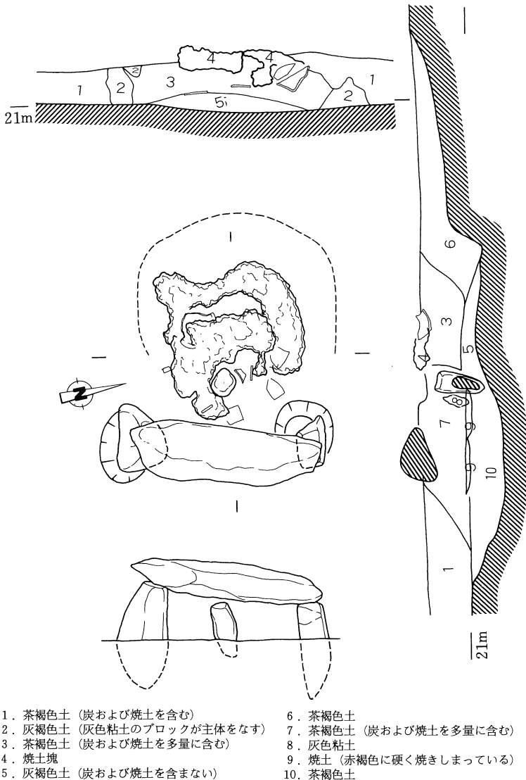
第4図 樋多田SB1カマド実測図
