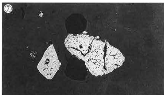
Photo.8 砂鉄粒子と羽口溶融物の顕微鏡組織
