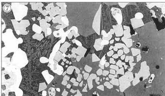
Photo.1 砂鉄製錬滓の顕微鏡組織
