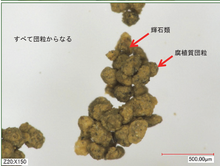
第198図 140号住居跡覆土の団粒・単粒各粒子の実体顕微鏡写真(1) 黄褐色土層 機械振とう処理済団粒代表写真
