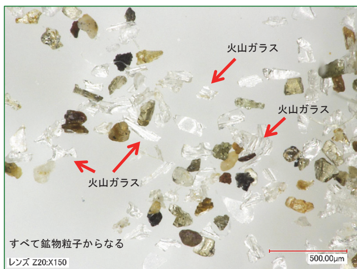
第199図 140号住居跡覆土の団粒・単粒各粒子の実体顕微鏡写真(2) 黄褐色土層 超音波処理済単粒代表写真
