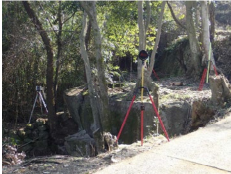
巨石のレーザースキャナー測量
