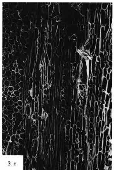
1 : オニグルミ No.65 2 : コナラ(アカガシ亜属)の一種 No.69 3 : コナラ(コナラ亜属コナラ節)の一種 No.24 a a; 木口×70 b; 柁目×140 c; 板目×140
