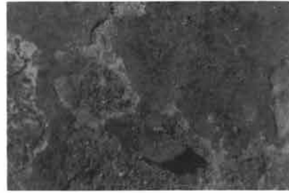
写真-2 褐色の膜状部分の 顕微鏡写真 (×25)
