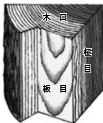
図3-1 木材の基本的3断面
