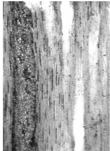
横断面 ————— : 0.5mm 放射断面 ————— : 0.2mm 接線断面 ————— : 0.5mm 11. サンプル番号4 コナラ属アカガン皿属
