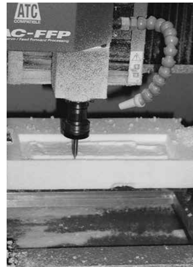
第44図 NC工作機による模型製作
